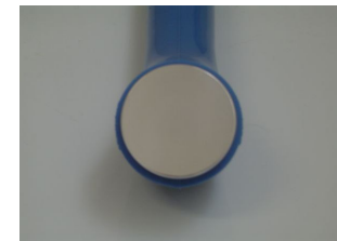
Figuras 2 y 3 – Transductor de ultrasonido visto de diferentes ángulos.
