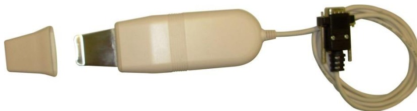
Figura 1. Transductor espátula para peeling ultrasónico, modo ultrasonido (sonoforesis), terapia combinada - ultrasonido con microcorriente (MENS) o ultrasonido con microgalvánica (GMES) o terapia aislada con microcorriente (MENS) o con microgalvánica (GMES).
